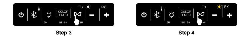
**注意:** 当扬声器同步后, 主扬声器的TX指示灯和接收器的RX指示灯将一直保持亮起状态。
